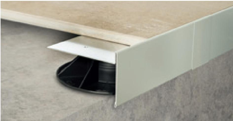
Protec CPLV ist eine Produktreihe zum Schutz und Abschluss. Ausführung in Aluminium pulverbeschichtet RAL 7038, bestehend aus einem bereits gebohrten Basisprofil CPLB, das mit Schrauben am Boden verankert wird, das Oberteil wird mit Kleber befestigt. Erhältlich in 3 Höhen entsprechend der Bodenbelagsstärke.
