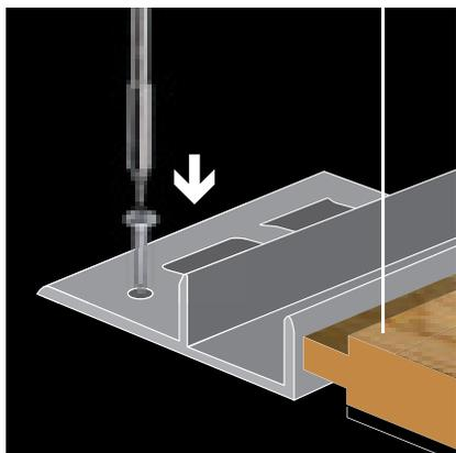
*Befestigen des Aluminium Basisprofils mit dem Untergrund mit Schrauben oder Kleber*
