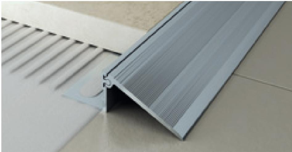
Pronivel NZS / ist eine Verbindungslinie der Höhendifferenz von Böden. Zusammengesetzt aus einem Trägerprofil und zwei Verbindungsflügeln von unterschiedlicher Größe. Der Absatz zwischen Böden unterschiedlicher Stärke wird beseitigt. Die Verbindung ermöglicht viele Kombinationen und die Verlegung eines neuen Bodenbelags auf der Seite des Anschlusses, auch nach der Anwendung der NZS.
