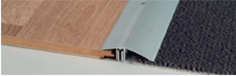
Bei der Produktreihe ALFIX® 616 handelt es sich um ein professionelles System zur schwimmenden Verlegung von Parkett und Laminat mit den Stärken 6 bis 16 mm. Die Top-Profile werden mit den beigefügten Schrauben, welche farblich auf die Profile abgestimmt sind, auf dem Basisprofil befestigt.
