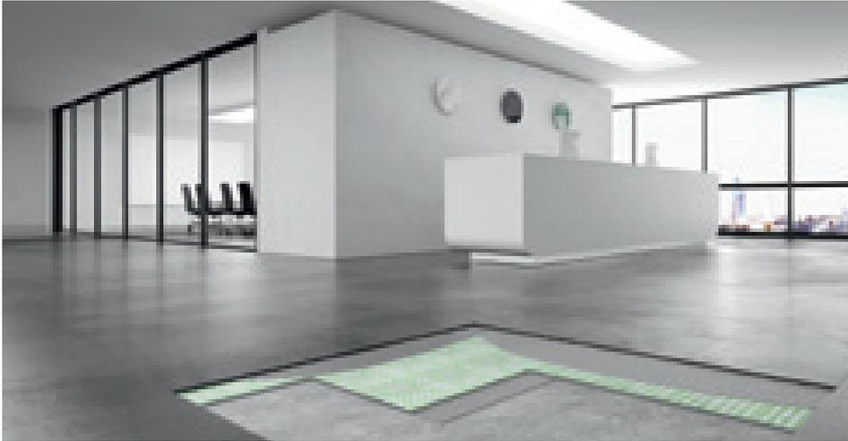
WPstop 3 ist eine Abdicht- und Entkopplungsbahn für den Innen- und Außenbereich. Sie ist besonders für den Badbereich, Balkone und Terrassen und problembehaftete Untergründe geeignet. Zum Verkleben der Bahn auf dem Untergrund werden ein Fliesenkleber der Kategorie C2 S1 empfohlen, zum Überkleben der Bahnzusammenstöße die elastischen Dichtbänder PBE30 oder PBE5 und ein Polymerkleber MS (Typ PP/96).
