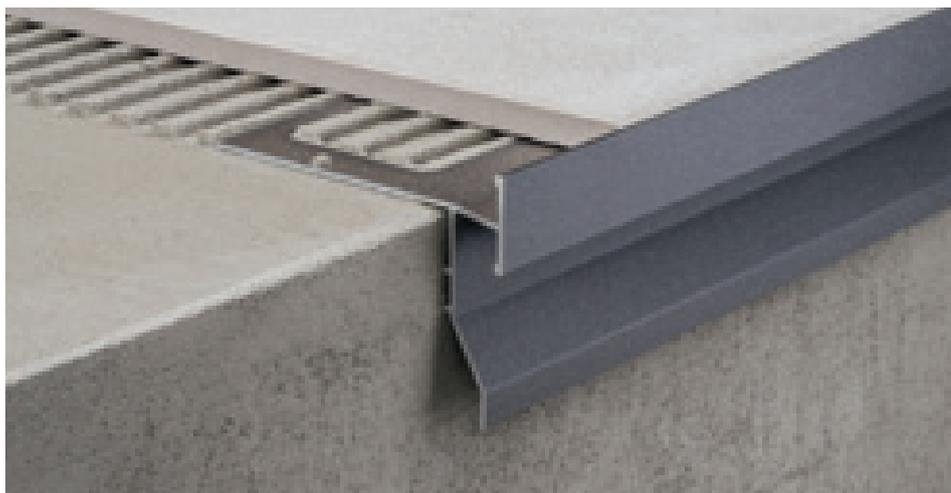
Protec CPGV ist eine Profillreihe für den Schutz und die Veredelung von den Außenkanten der Terrassen und Balkone. Das Profil hat einen vertikalen Teil, der den Boden bedeckt und den Ablauf des Wassers aus dem Fliesenboden ermöglicht; eine gelochte Tropfkante ermöglicht den Abfluss des Wassers unter der Fliese. Die Probleme mit dem Einfrieren und dem Auftauen verringern sich.
