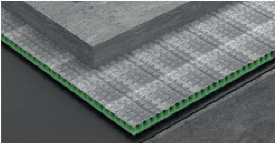
WPstop Drain 10 ist eine Drainagematte aus hochdichtem Polyethylen (HDPE) mit Kegelstumpfstruktur und einem Filtervlies auf der Oberseite. Wpstop Drain 10 entspricht der UNI 11493-1 Norm, die bei einer Abdichtung unter dem Estrich eine Ablaufmöglichkeit vorschreibt.
